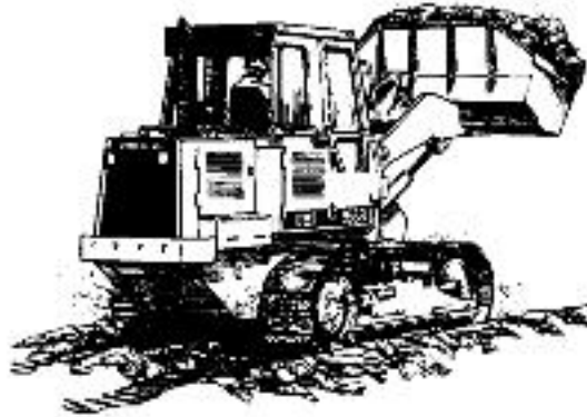
b Chargeuse sur chenille en cours de déplacement
